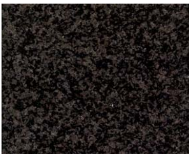
D9 –kamenné kostky 10/10/8 cm – štípané pravidelné světlé - typ liberecké žuly
